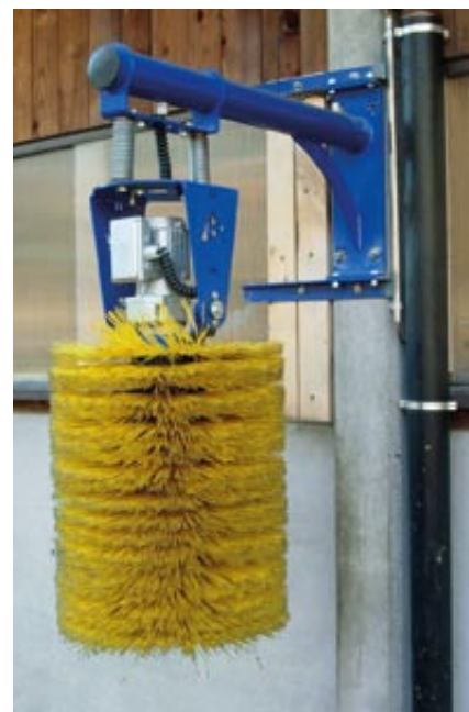
Brosse rotative pivotante installée dans la courette
